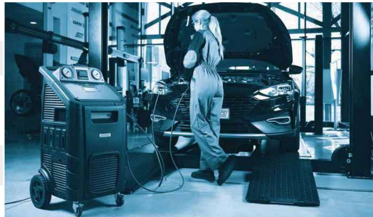
ECK 1900 PRO está diseñada para diferentes tipos de refrigerantes. ECK 1900 PRO enriquece el equipo con un contenedor adicional de aceite/trazador y un calentador de tanque. La función Hybrid es estándar. Las funciones opcionales adicionales, hacen de esta estación una solución eficaz y flexible.
