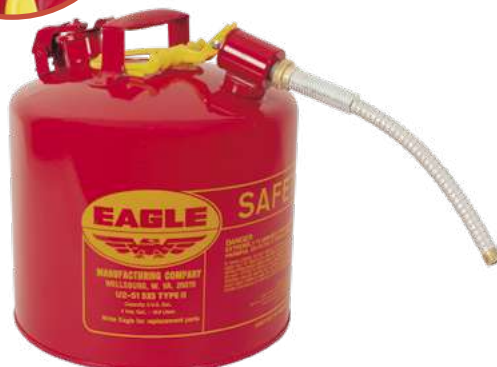
TAPÓN DE LLENADO DE CIERRE RÁPIDO, QUE PERMITE VENTILACIÓN A LOS 5 PSI DE PRESIÓN INTERNA
